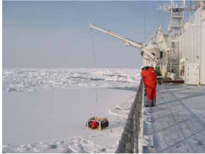
船上からクレーンを使って観測者と観測器材を氷上に運んで海水コアを採取
