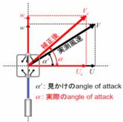
図 10 実測および補正後の風速ベクトルと angle of attack の説明図
